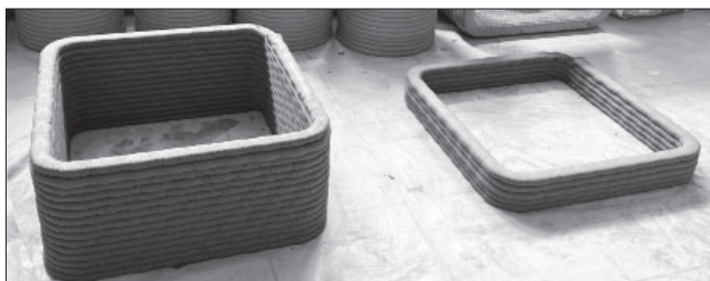
Рис. 7. Изделие для выпиливания образцов прямоугольных стенок в форме квадратного колодца с высотой печатного слоя 2 см, изготовленное в процессе непрерывной печати (слева), и первая треть аналогичного изделия с имитацией «холодного» шва (справа)
