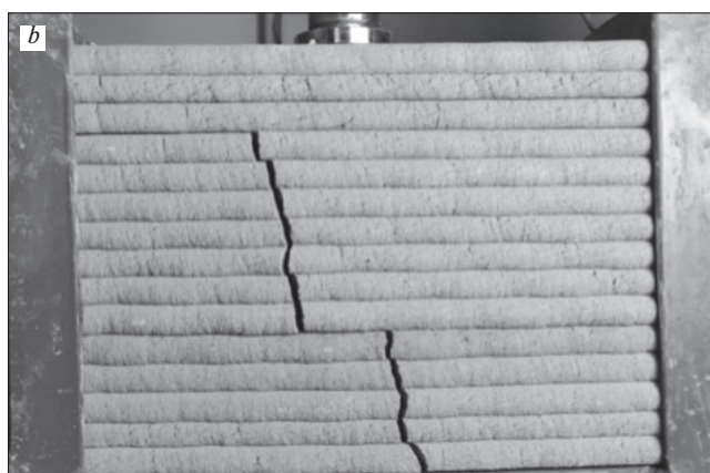
Рис. 18. Характер разрушения прямоугольного элемента несъемной опалубки с высотой печатного слоя 2 см: без холодного шва (а) и с холодным швом (б)
